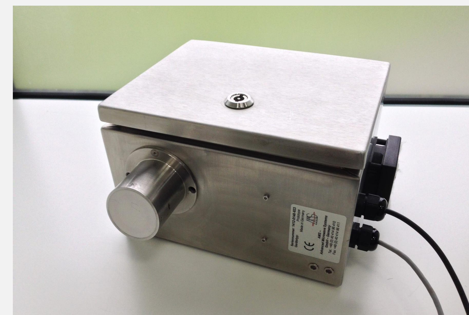
Fig. 2: MRT sensor (sensor head ø 5.5 cm)
