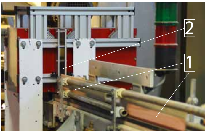
Kaum größer als ein Werkzeugkasten ließ sich das Döscher & Döscher Präzisionsfeuchtemessgerät in die bestehende Anlage integrieren – in Windeseile passieren die stehend geführten Decklamellen (1) die Feuchtekontrolle (2)
