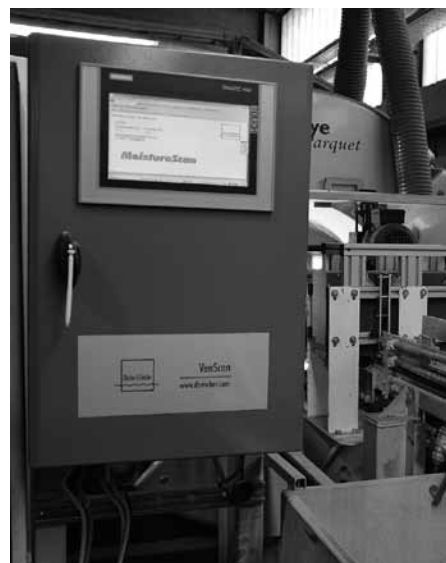
Die Steuereinheit des Feuchtemessers schafft mindestens 50 Messungen auf jeder Decklamelle
