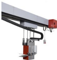
Abb. 10: VenScan in einer Verfah-Einrichtung (LMS)
