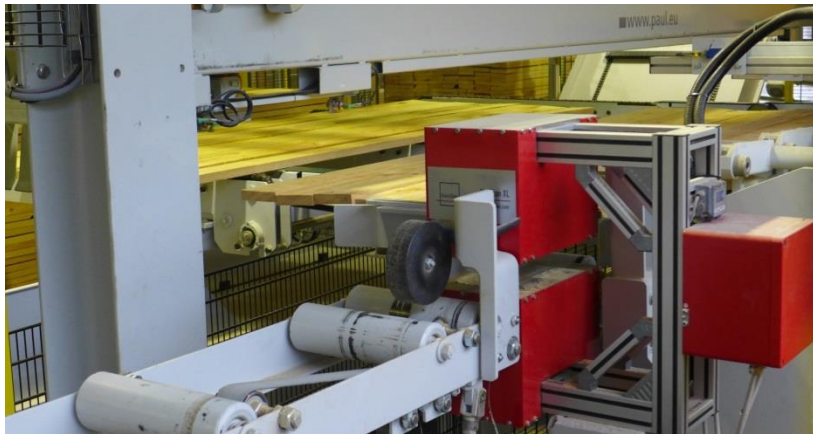
Abb. 13: VenScan XL in einer Wareneingangskontrolle
