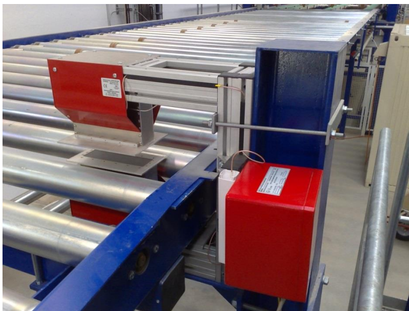
Abb. 14: VenScan XL in der Warenausgangskontrolle bei MDF-Platten
