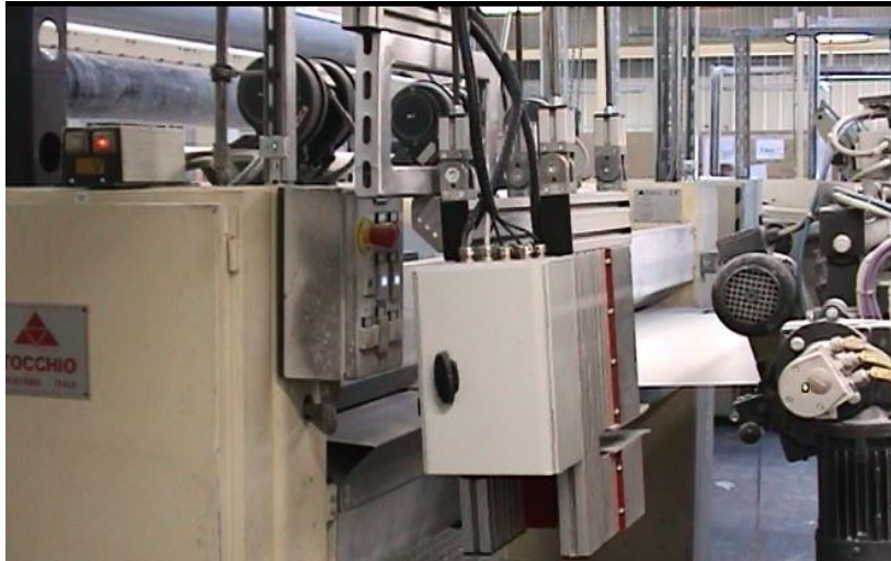
Abb. 16: VenScan LMS Sensor in der Folienproduktionslinie
