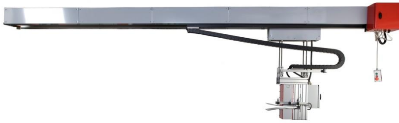
Abb. 15: VenScan LMS Sensor in der Verfahr-Einrichtung
