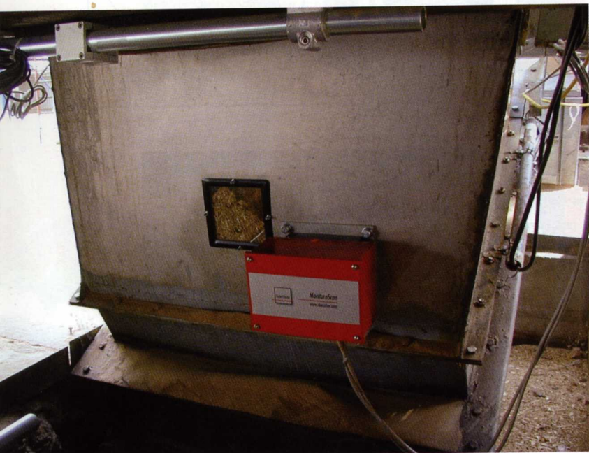
Twee voorbeelden van een 'in line'-vochtbepaling
