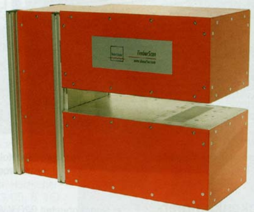
TimberScan für Feuchtemessung bei Massivholz bis zu 50 mm Dicke FOTOS: DÖSCHER & DÖSCHER
