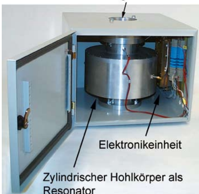
Abb. 3: Fotografie eines Hohlraumresonators. Das zu messende Material wird durch den Resonator hindurch geführt.
