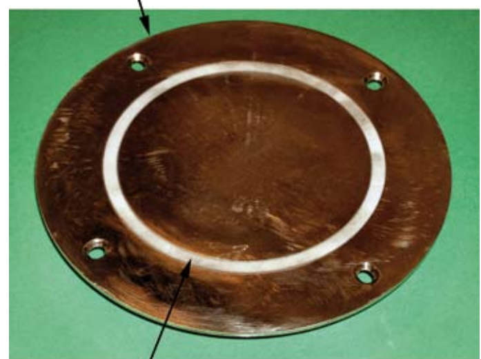
Abb. 4.: Aufbau eines Streufeld-Resonators. Ein Streufeld durchdringt das zu messende Material. Der keramische Wellenleiter und die metallische Grundplatte sind so hart, dass der Aufbau rauen Produktionsbedingungen standhält.
