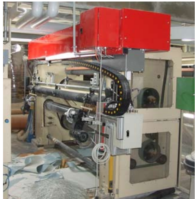
VenScan-LMS montiert hinter dem S-Bogen (Kühlwalzen).
